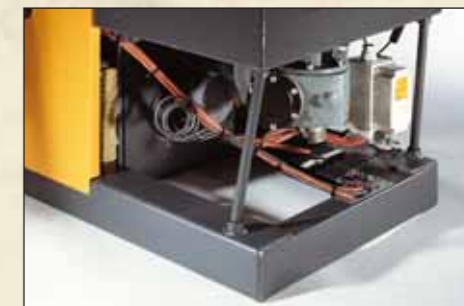
Der Brennstoffmotor und das Getriebe für den Schubboden, Anschlusskasten für den elektrischen Gebläsemotor.
