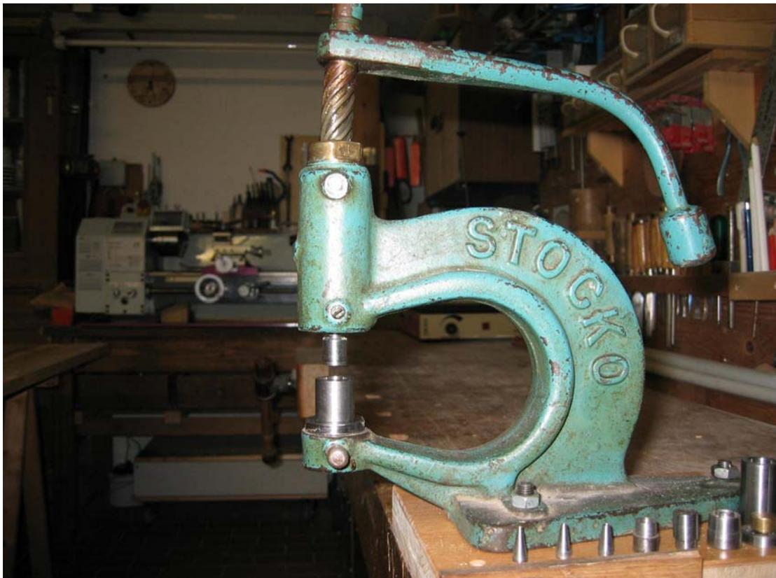
**Handpresse mit Metallzylinder und Pressaufsatz**
