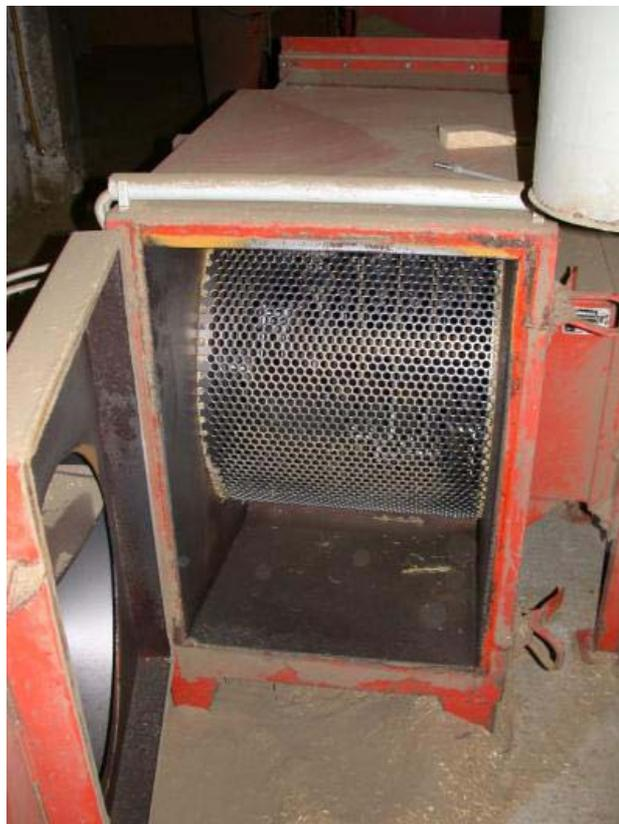
**In dieser Hammermühle wird das Stroh zu Pulver zerkleinert ....**
